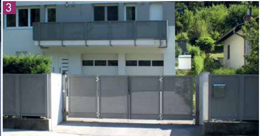
FALT-DREHTOR mit Lochblechfüllung
